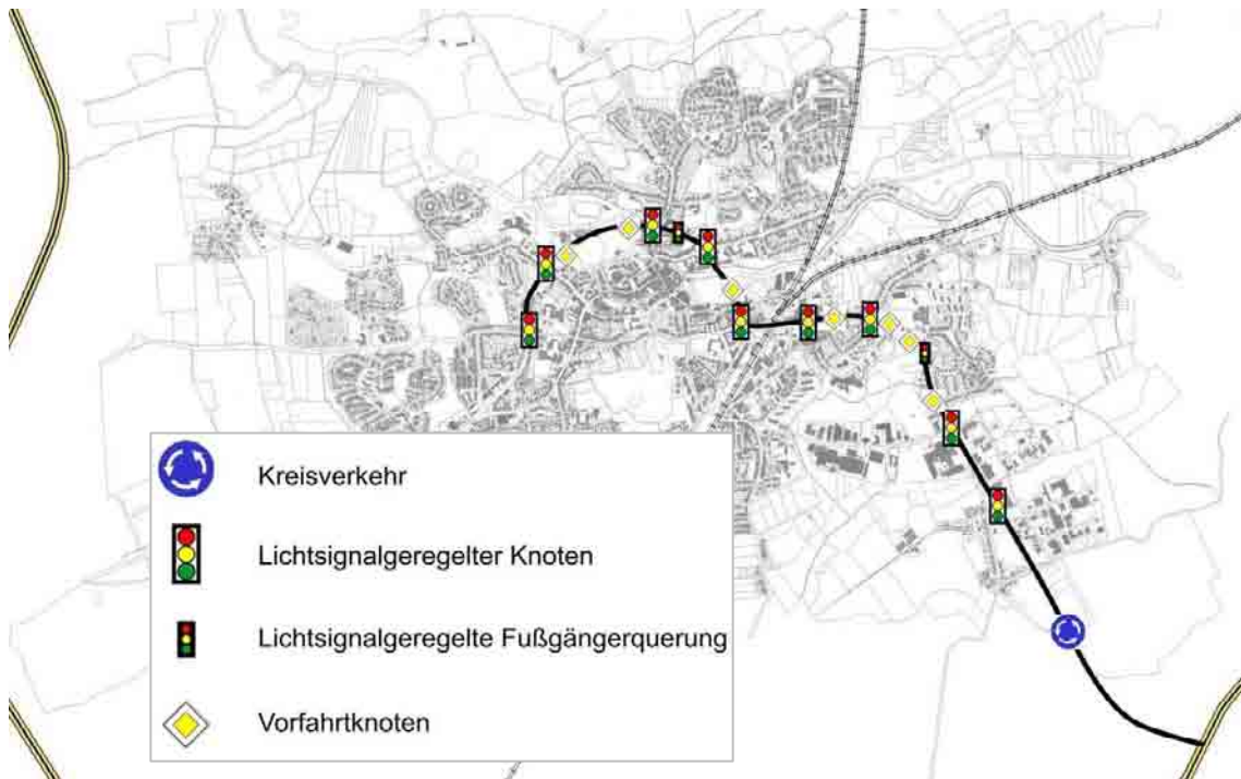
Abbildung 13: verkehrstechnische Gestaltung der Knotenpunkte und lichtsignalgesteuerte Fußgängerquerungen im Untersuchungsnetz
